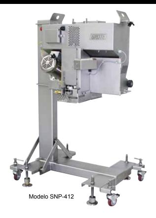
Corta y aplica el producto sobre receptores en movimiento a velocidad de hasta 120 cortes por minuto un único carril.
