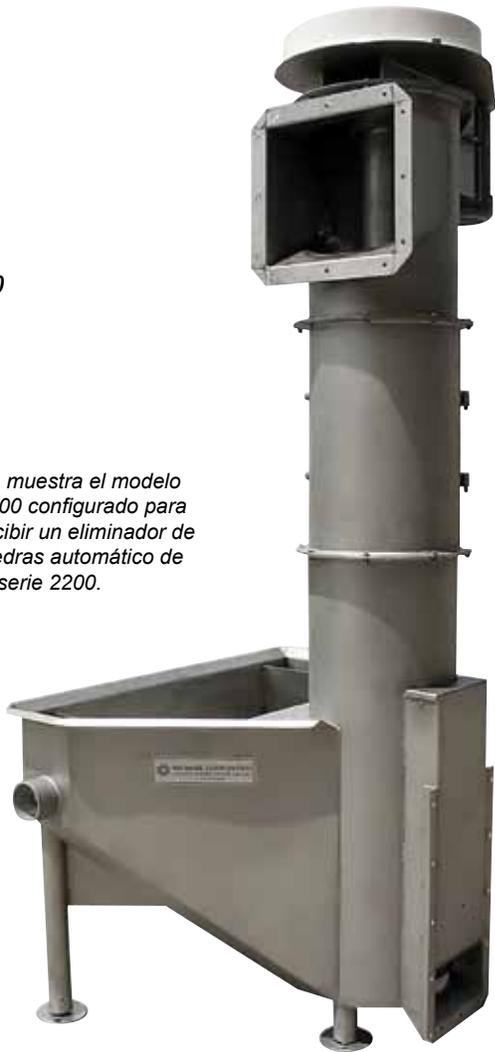
El elevador hidráulico/eliminador de piedras Vanmark puede ser adecuado para muchas aplicaciones de productos. Cumple dos funciones clave. Primera, enjuaga el producto y separa los desechos que no flotan del flujo del proceso. Segunda, eleva el producto utilizando un mínimo de espacio de piso.
