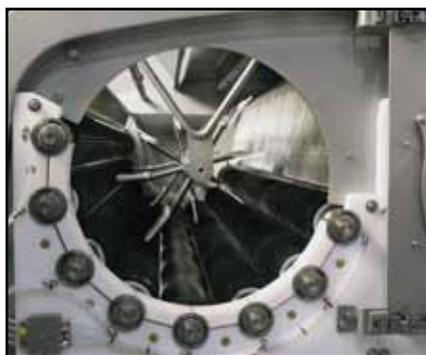
Descarga final se muestra la configuración de lubricación automática.
